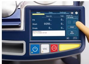
8. Justér om nødvendigt vakuumindstillingen ved hjælp af rullemenuen **Vakuum** i skærmbilledet **Hoved**.
