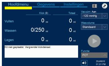
1. Deze melding verschijnt: **Kit niet geplaatst. Vergrendel klokdeksel.**
