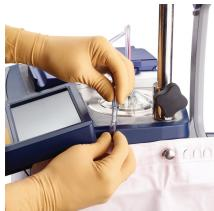
9. För in kopplingen med gult lock i inloppsporten med gult lock på avfallspåsen. Kontrollera att avfallsslagen inte är knickad.
