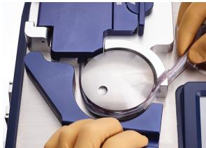
12. Trekk i pumpespaken og hold den åpen. Strekk pumpeslangen rundt pumpehodet og over kanalen for pumpens utløpsslange. Slipp pumpespaken.
