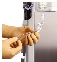
15. Koble manifoldens venstre slange til reduksjonskoblingen med blå hette på undersiden av reservoaret, og åpne deretter klemmen på reduksjonskoblingen.
