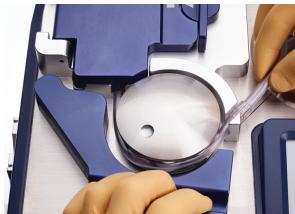
12. Dra i pumpspaken och håll den öppen. Dra pumpslangen runt pumphuvudet och över pumputloppsslängens kanal. Släpp pumpspaken.
