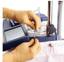
9. Steek de connector met gele dop in de inlaatpoort met gele dop op de afvalzak. Controleer of er geen knikken in de afvalslang zitten.
